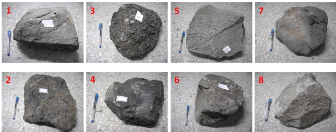
圖 87：用以進行材料力學性質測試的綠島基盤岩安山岩塊樣品
