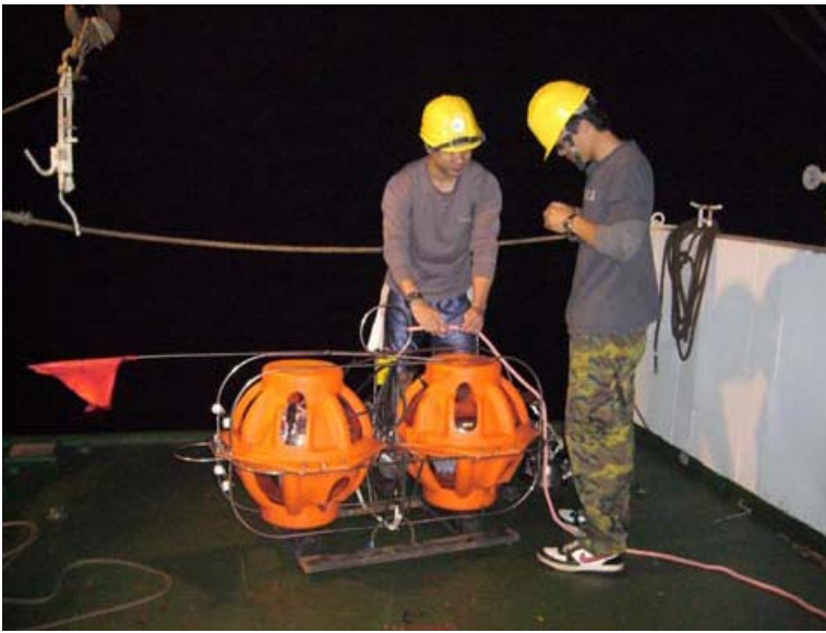
圖 68 IOOBS V2 採雙球型設計，新增電源供應浮球，連續紀錄時間可達 3 個月以上。
