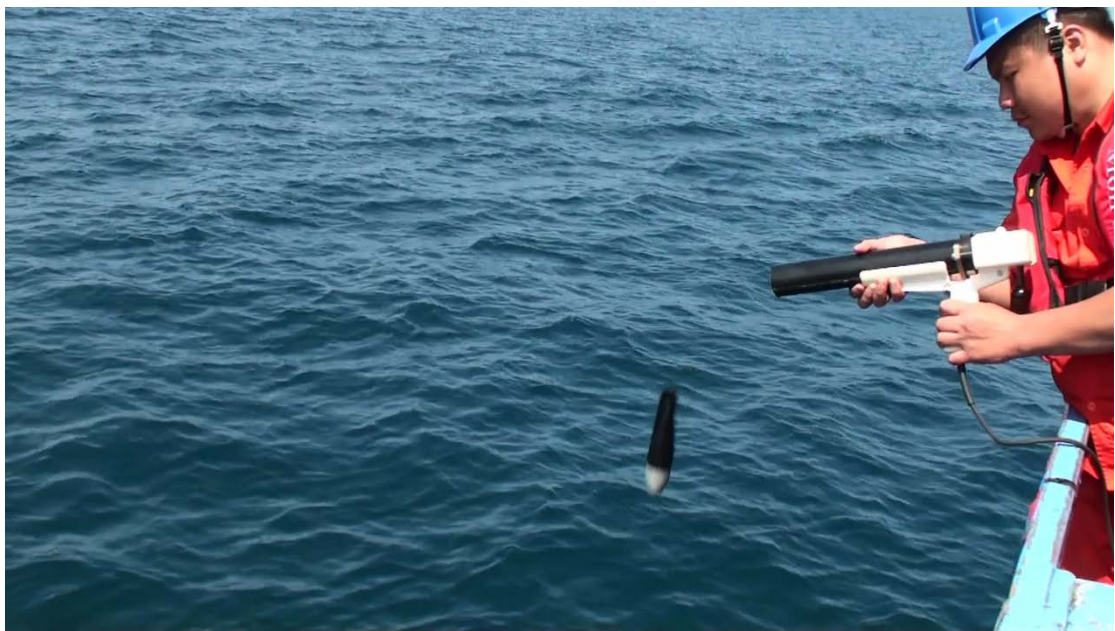
圖 48 作業同時，必須用 XBT 獲得水層的聲速剖面資料；照片為測量人員在發射 XBT 彈頭。
