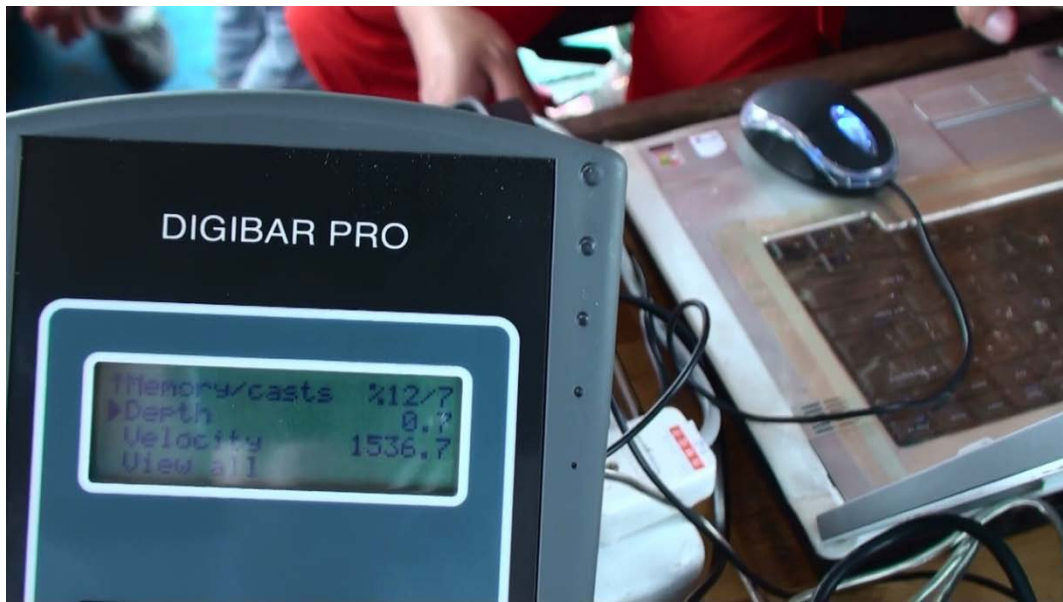
圖 45 作業時，表面聲速計數據資料的接收畫面。
