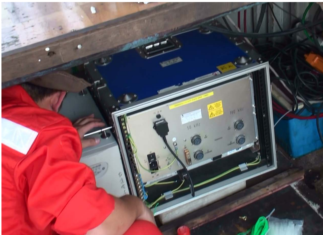
圖 40 SeaBeam 1050 多音束測深機主機，在本計劃作業中架設在漁船上。
